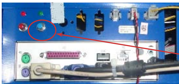
Рис. 14. Нажать кнопку включения компьютера
