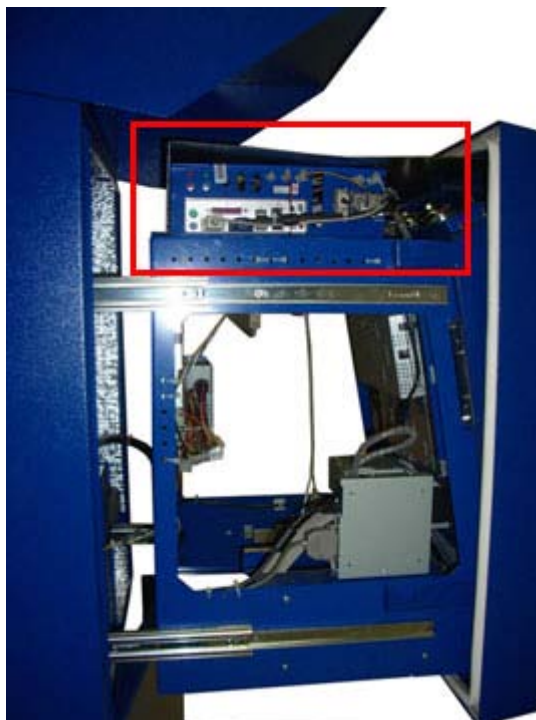
Рис. 4. Расположение компьютера в компьютерном отсеке
