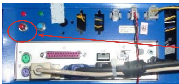
Рис. 15. Нажать кнопку перезагрузки компьютера
