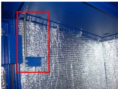
Рис. 6. Открыть компьютерный отсек с помощью рычагов
