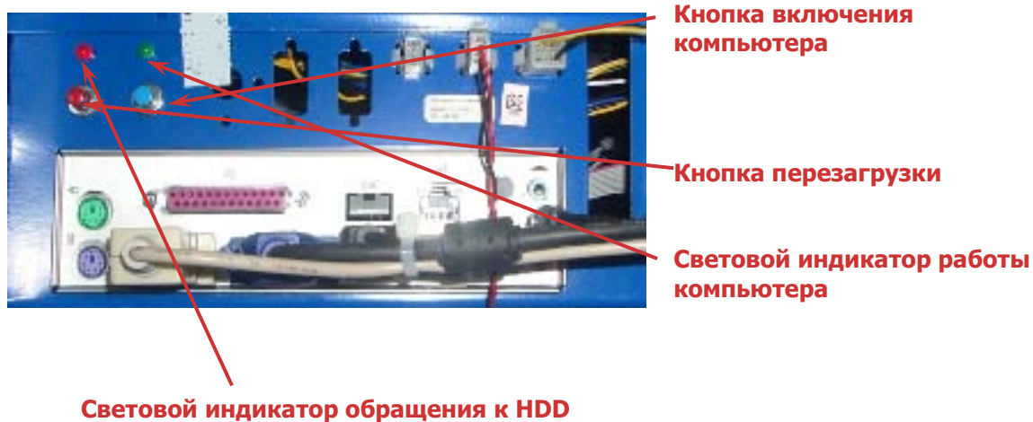
Рис. 12. Общее расположение элементов главной панели
