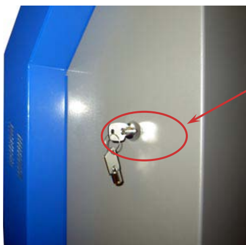
Рис. 22. Включение компьютера ключом электромеханического замка
