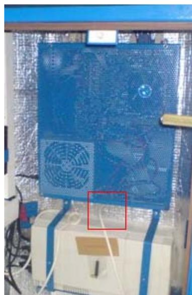
2. Подключите силовой провод внутри автомата к блоку розеток.
